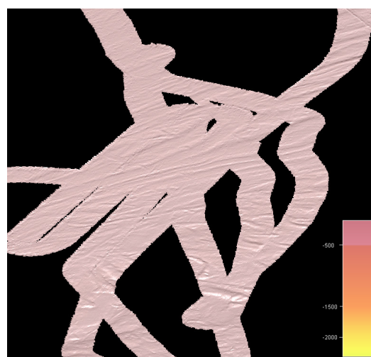
ケープダンレー沖海底地形。リニエーションあるいはメガフルートと考えられる地形が見られる。浅い箇所では溝の方向は一定でない。
