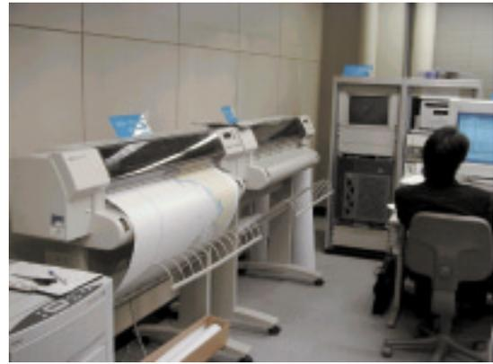
写真3 出力制御装置 (インクジェットプロッタ).
