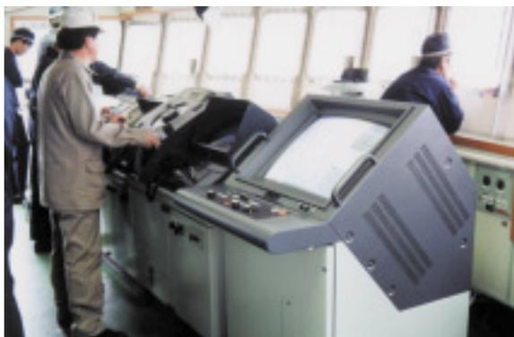
写真9 測量船「海洋」に搭載のECDIS。
