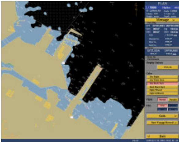
図15 航海用電子海図の夜間モード表示例。
