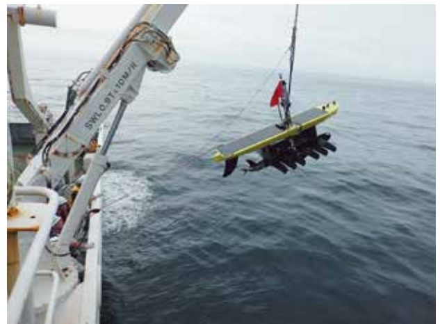
Photo 2. Launching the AOV. 写真2. 自律型海洋観測装置 (AOV) 投入作業.
