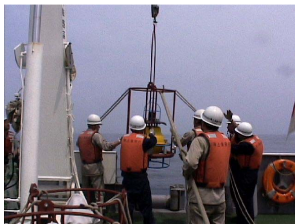
写真 3 トランスポンダの投入作業。
