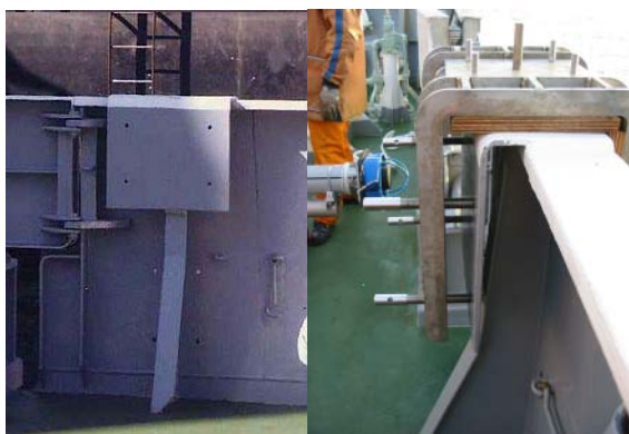
写真7 常設した台座と台座上の鞍。
