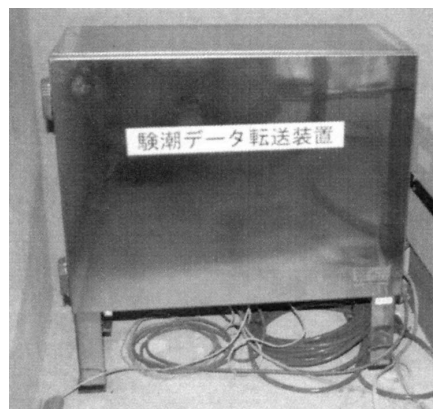
写真1 験潮データ転送装置 Photo 1 Tidal Observation Data Transmission Device
