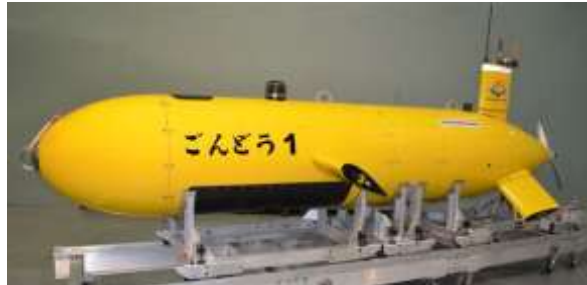
AUV「ごんどう」の外観。全長 4.3 m、重量 610 kg
