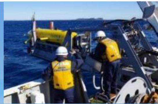
泥などの海底堆積物を採取する機器の投入作業
