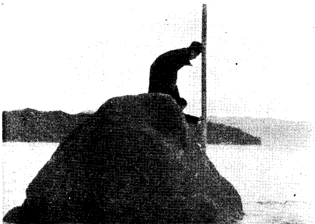
高知港口にある狹石（高さ2.5メートル）に於ける測量 今次測量の結果高さ1.9メートルとなり、0.6メートル沈下
