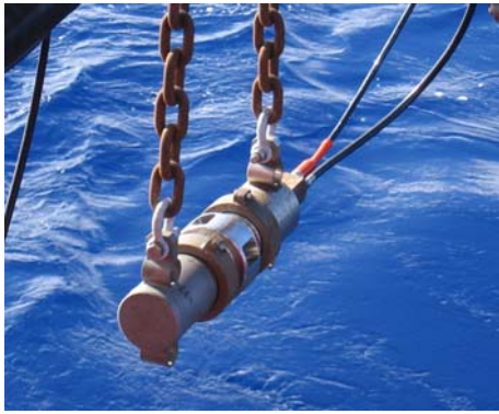
エアガン・・・高圧の空気を海中で一気に放出し、音波(地震波)を生み出します。
