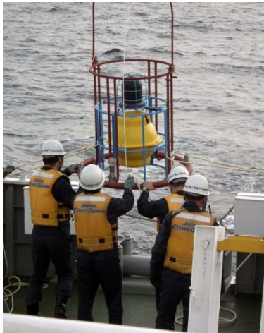
海底基準局の投入作業
