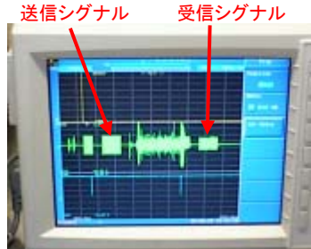
観測した音響測距波形 (送受信の時間差から距離を測定)
