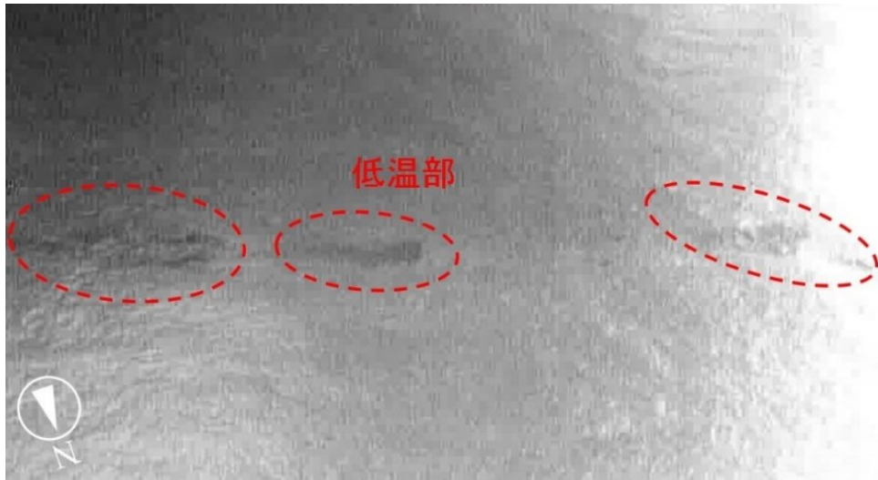
図2 熱画像（黒く見える部分が低温部）（8月11日撮影）
