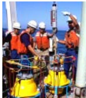
海底基準局の投入作業
