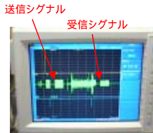
観測した音響測距波形 (送受信の時間差から距離を測定)
