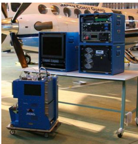
Photo.1 SHOALS1000型航空レーザー測深機
