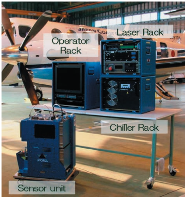
写真1 航空レーザー測深機 SHOALS 1000 Photo.1 Components comprising the airborne system of SHOALS 1000.
