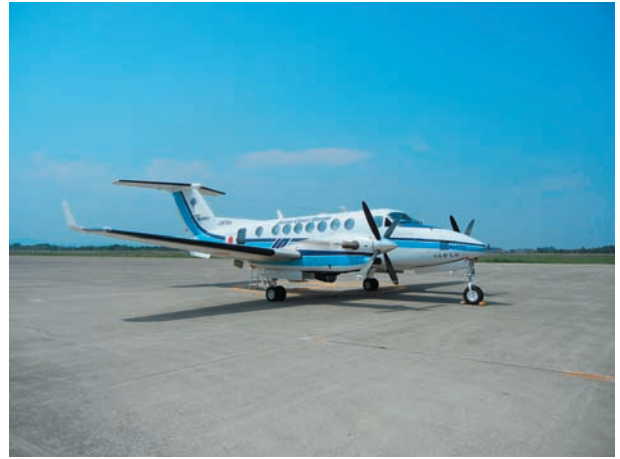
写真2 航空レーザー測深機搭載航空機 ビーチクラフトキングエア B 350 「JA 870 A」 Photo.2 Aircraft equipped with the LIDAR system, Beechcraft King Air B 350 "JA 870 A".
