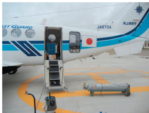
写真5 航空レーザー測深機の整備作業（窒素ガス充填中）
