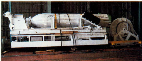
写真3 深海用曳航式サイドスキャンソナー (Sys09) (愛称 ANKOU アンコウ)
