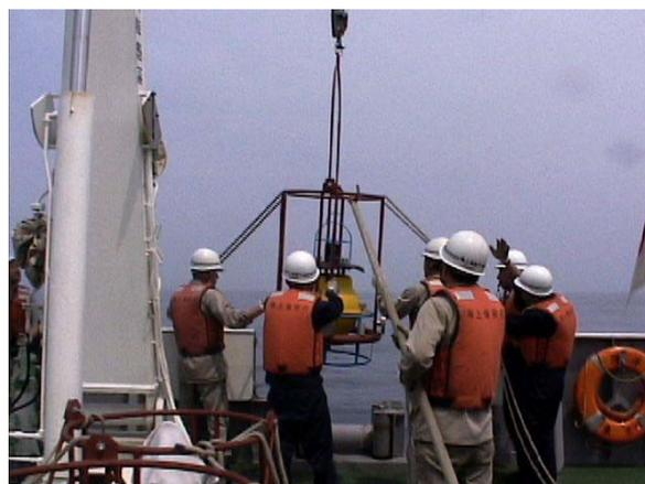
写真 3 トランスポンダの投入作業。
