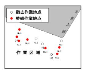
18年581項 北海道南岸 - 苫小牧港、第4区 灯付浮標等点検作業 下図に示す8地点で、作業船・潜水士による灯付浮標及び導灯の点検作業が実施される。
