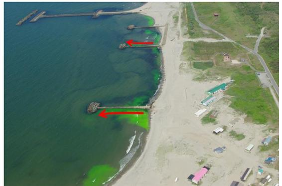
離岸流が、人工構造物(突堤)に沿って発生
