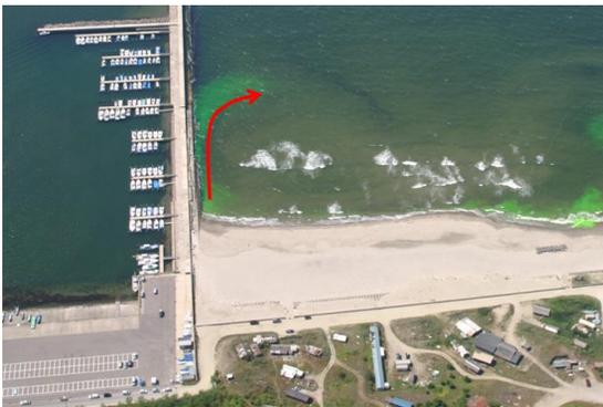
離岸流が、人工構造物(防波堤)に沿って発生
