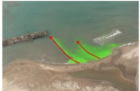
離岸流が、人工構造物(離岸堤)端を通過するように発生
