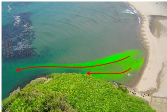
離岸流が、岸と人工構造物(潜堤)の間を抜けるように発生
