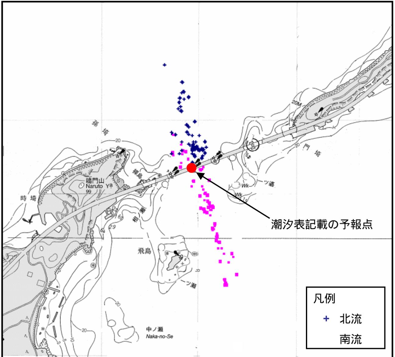
海峡及び付近の潮流観測は、測量船「うずしお」搭載の多層超音波流速計を使用して、同船が海峡を反復通行する方法で実施しました。上図の+及び の位置は通行毎の最大流速を観測した位置です。
