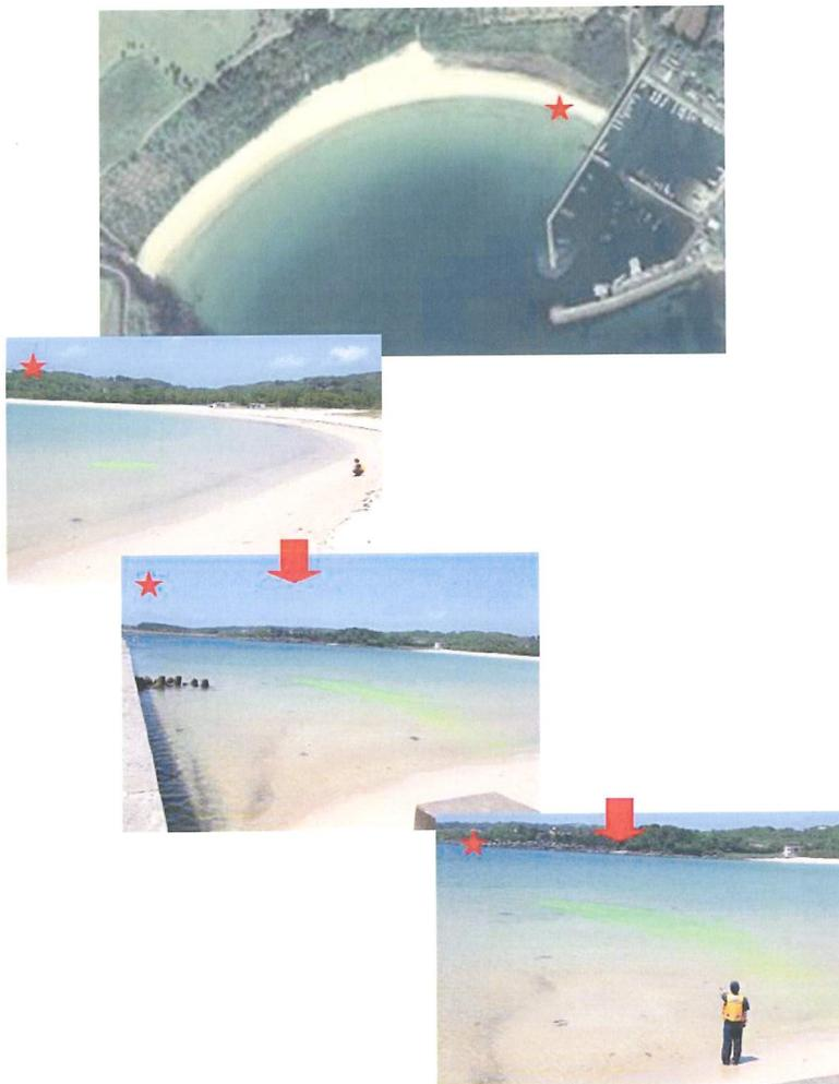
下の写真は海水浴場中央部にてシーマーカーを流した結果です。このように場所によっては、離岸流は見られず、シーマーカーはその場で拡散したり、海岸線に沿って(並岸流)しています。しかし、波風の状況によってはこうした場所でも離岸流が発生する場合があります。
