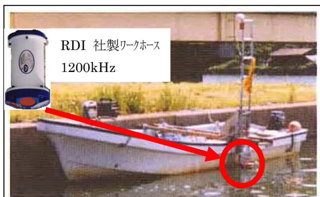
図2 超音波流速計を作業船に艀装
