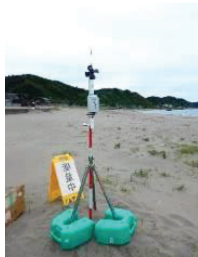
写真4 風向風速計の設置状況
