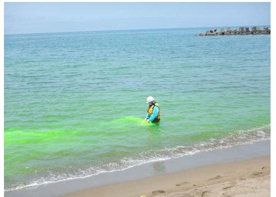
写真2 着色剤の散布状況
