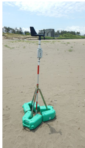
写真4 風向風速計の設置状況
