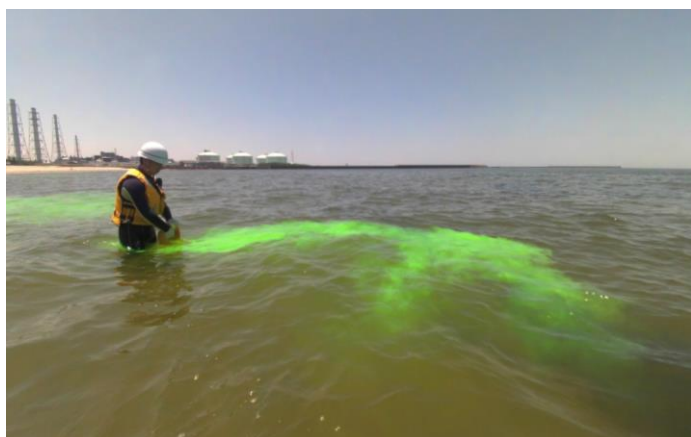
写真2 着色剤の散布状況
