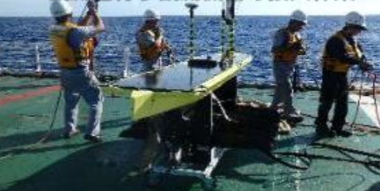
泥などの海底堆積物を採取する機器の投入作業
