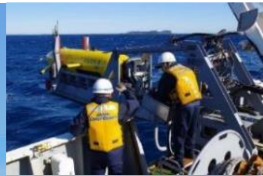
自動で潜航して海底地形等を調査する観測機器の投入作業
