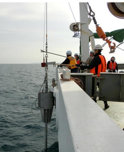
泥などの海底堆積物を採取する機器の投入作業
