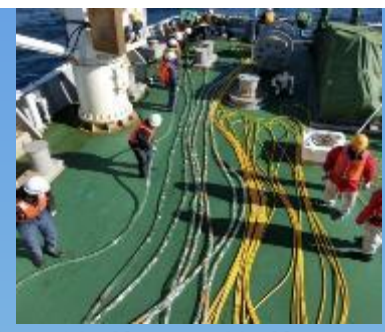
地殻構造調査に使用する音波の発信装置と受信装置
