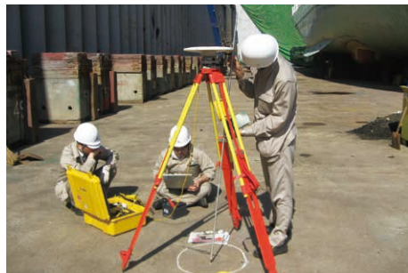
GNSSアンテナ 船底音響トランスデューサ間位置測定の様子
