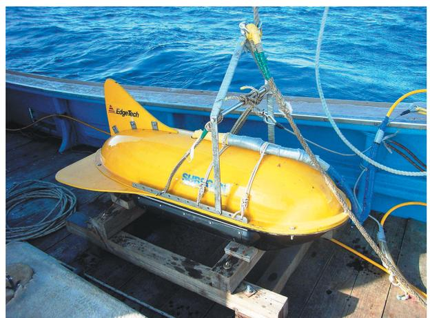
写真3 音波探査装置 (FS-SB SB-216 S)
