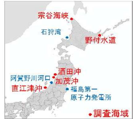
日本海及びオホーツク海における福島第一原子力発電所に由来する人工放射性物質の移行経路を同定するため、これまでに野付水道、宗谷海峡、酒田沖、加茂沖及び直江津沖の海底土を採取し放射能を測定した。その結果、直江津沖を除く調査海域で福島第一原子力発電所に由来する $^{134}\text{Cs}$ を検出し移行経路を示唆する結果を得たので報告する。
