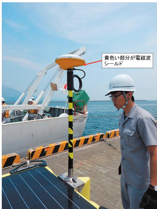
Photo 9. GNSS antenna with electromagnetic wave shield (yellow part). 写真9. 電磁波シールド（黄色い部分）を取り付けたGNSSアンテナ。
