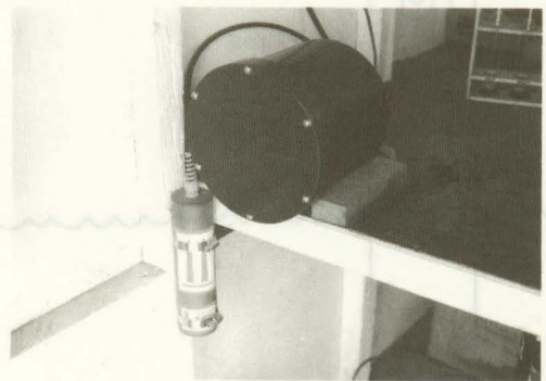
写真4 水圧式験潮器 (ENDECO Model 1029)
