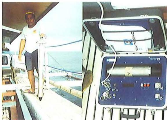
写真5 NAVITRONIC 社製の音速度計, SVP-1/SVM-1
