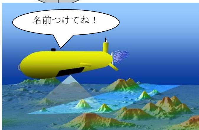
AUVは、母船との間にケーブル等を必要とせず、あらかじめプログラミングされた情報に基づき無人で自律的に海中を航行し、数千mの深海底付近で、搭載した各種調査機器により精密な海底地形等の調査を行います。
