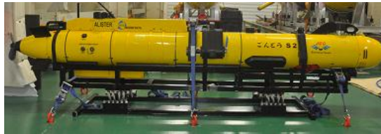
AUV「ごんどう S」の外観。全長 2.5 m、重量 96 kg
